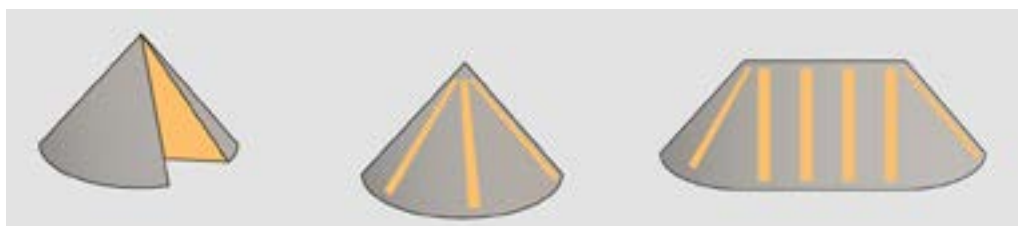
Fig. 20 : Répartition des coupes à la surface d'un tas constitué de matériaux homogènes Hypothèse : Tas homogène, dont le cœur présente des propriétés identiques à celles de la surface (selon [a])
